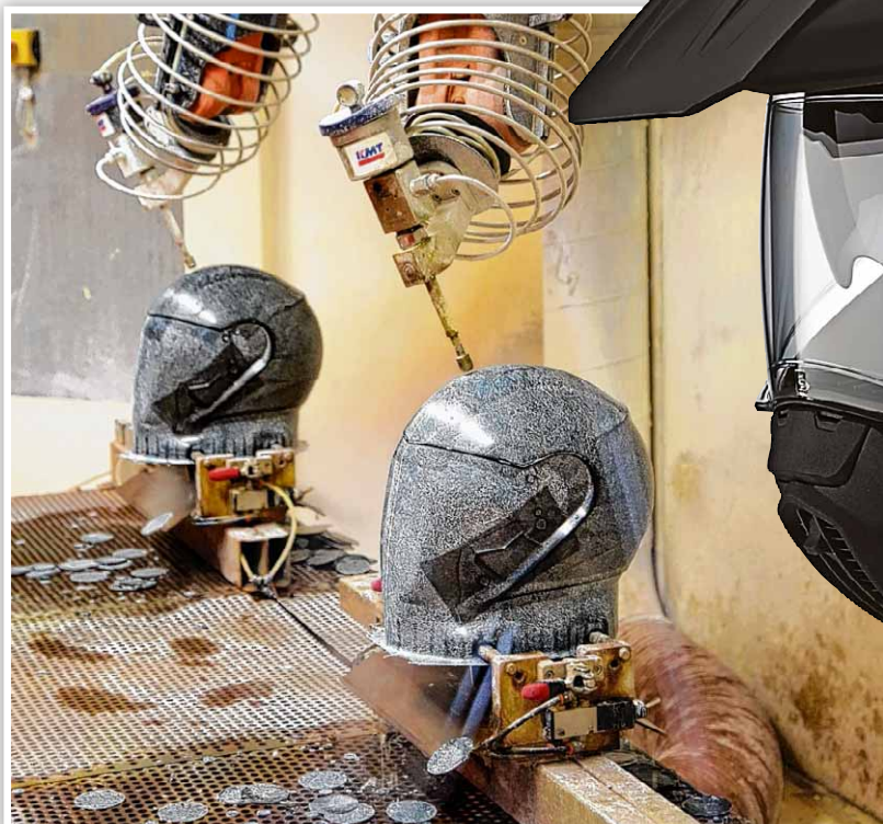
Mit einem Druck von 4000 Bar werden Belüftungslöcher und Löcher für die Visiermechanik in die Helme geschnitten. Fotos (5): Viktoria Kühne
