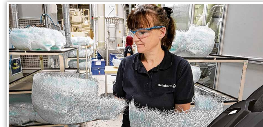
Mitarbeiterin Ellen Schröder mit einer Helmschale, die mit dem Direct-Fiber-Processing-Verfahren hergestellt wurde.
