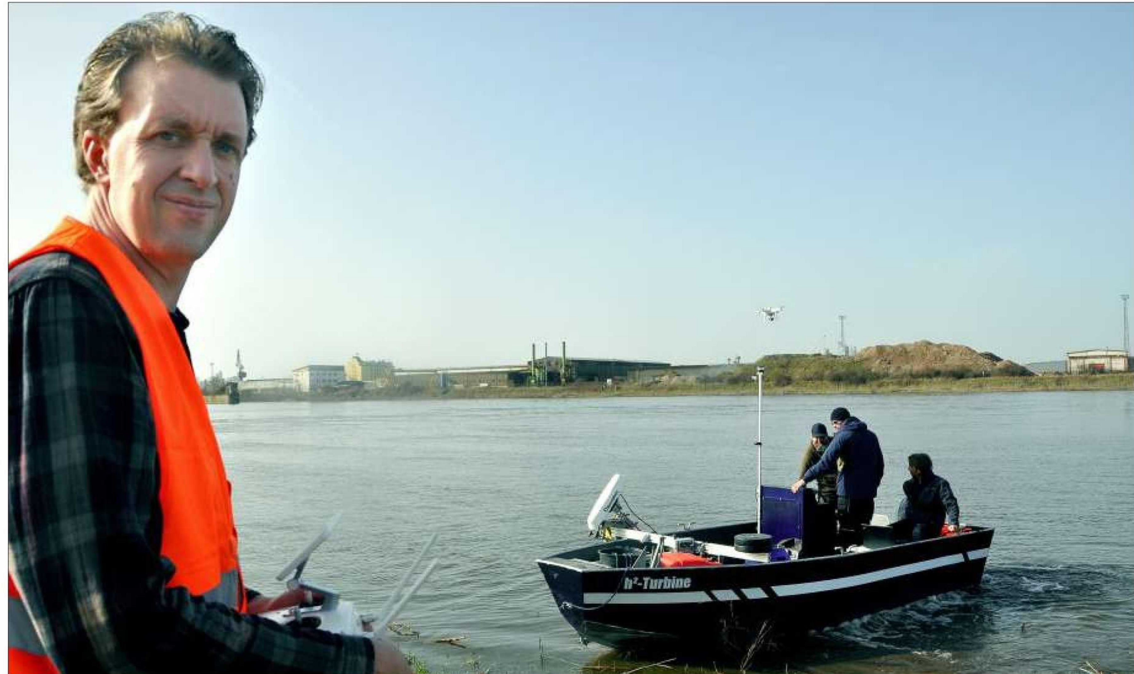
Während seine Kollegen das Messboot auf der Stromelbe startklar machen, hat Daniel Hesse von der Hochschule Magdeburg-Stendal bereits die Messdrohne in die Luft gebracht. Mit Fächerecholot vom Boot aus und Luftaufnahmen per Messdrohne nehmen die Wissenschaftler die Strom- und die Alte Elbe unter die Lupe. Fotos: Ivar Lütke
