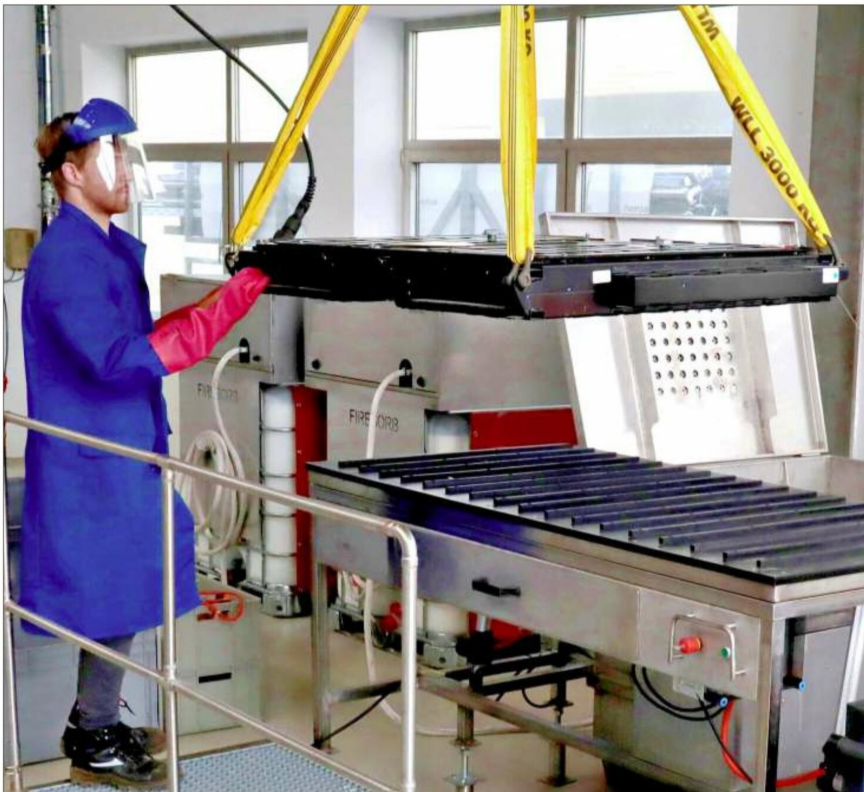
Kein Vergleich zur klassischen Autobatterie: Eine E-Auto-Batterie wiegt bis zu 700 Kilogramm. Ihre Demontage bedarf einigen Aufwands. In Magdeburg sollen in einer neuen Anlage jährlich bis zu 15 000 Tonnen behandelt werden.
