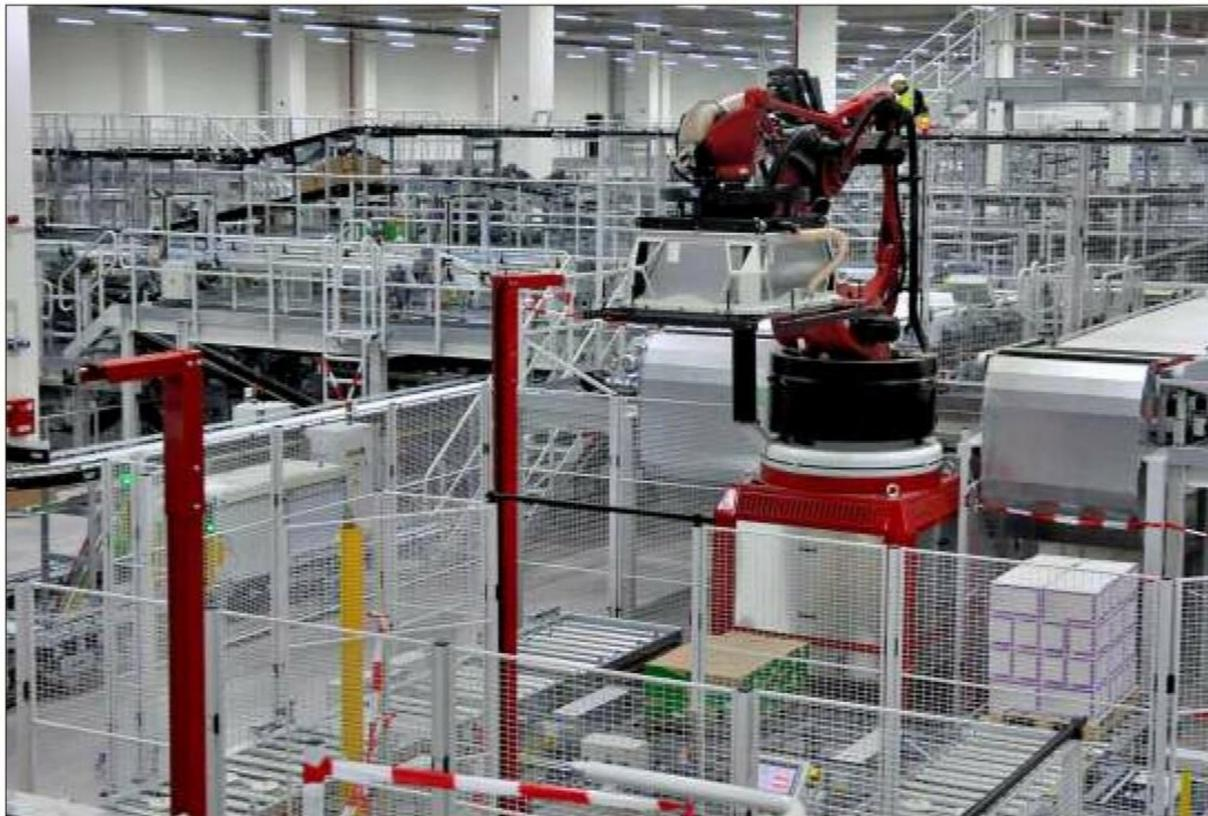
Der „Depalettierungsroboter“ saugt die Ware Schicht für Schicht von der Palette und verteilt sie weiter.
